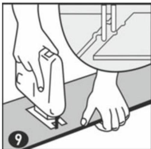
Отверстия под трубы делайте так: измерьте диаметр, добавьте 12 мм и вырежьте отверстия в панели. Для этого разрежьте панель пополам, уложите обе части и склейте их клеем для ПВХ. Удалите выступившие излишки клея и оставьте под прессом на сутки.
