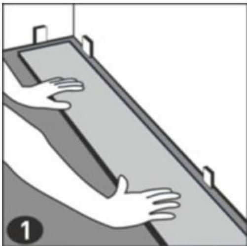
Между стеной и панелью оставьте зазор 8–10 мм, используя клинья
