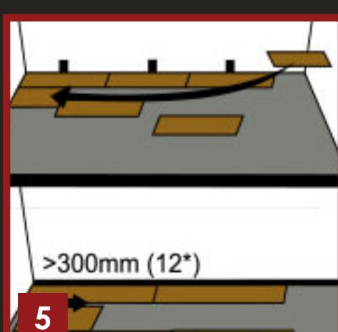
Для монтажа второй доски второго ряда, вставьте доску по длинной стороне в замок доски первого ряда, а затем вставьте торцевую часть монтируемой доски в торцевую часть первой. Аккуратно защелкните замок, подстучите прорезиненным молотком (киянкой). Соберите второй ряд до конца (рис. 6).
