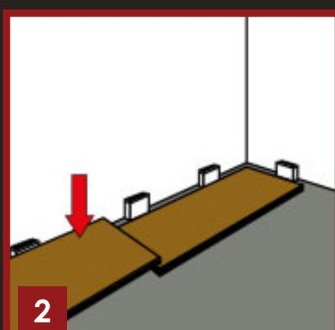
Монтаж второй доски первого ряда осуществляется следующим способом: вставьте торцевую часть монтируемой доски в торцевую часть первой. Аккуратно защелкните замок. Используя резиновый молоток, подстучите ламель, чтобы обеспечить полную сцепку досок на одном уровне высоты. Продолжайте укладку (рис. 2).
